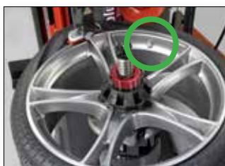
Demontage oberer Wulst
