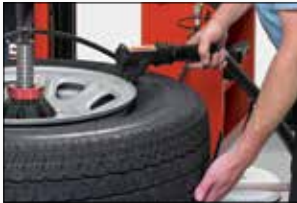
Schock-Befüllung - Schickt einen großen Luftstoß zur undichten Stelle.
