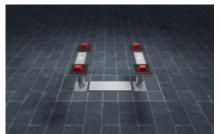
Der Stahlwannenkopf ist nicht mehr tragfähig, wird entfernt und der neue Rahmen wird montiert. Anschließend wird zubetoniert und die auf das Stahlwannenmaß angepasste Hebebühne der NxT Generation wird eingesetzt.
