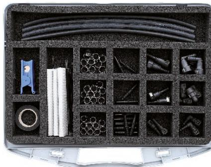
Bei Anwendung des AdBlue®-Reparatursetes wird die defekte Leitung einfach getrennt, die elektrischen Heizdrähte seitlich abgelegt, ein neuer Nippel mittels Spezialschlauch in die bestehende Leitung eingesetzt, die Heizdrähte wieder anmontiert und dicht ist die Problemstelle.
