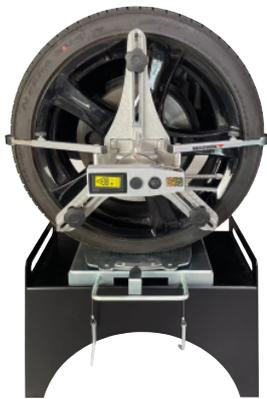
Das Carline CL20 ist ein kabelloses Laser-Achsmesssystem für Pkw. Die Achseinstellung erfolgt von Achse zu Achse. Die Eingangsvermessung wird im Fahrzustand durchgeführt.
