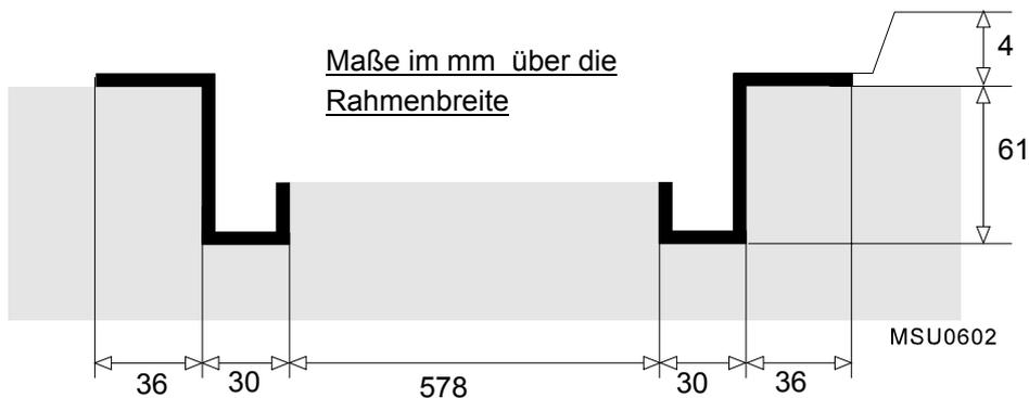
Falls Rahmen mit dem Bodenbelag bündig sein soll, die Materialstärke (4 mm) beachten und die Einbautiefe entsprechend korrigieren.
