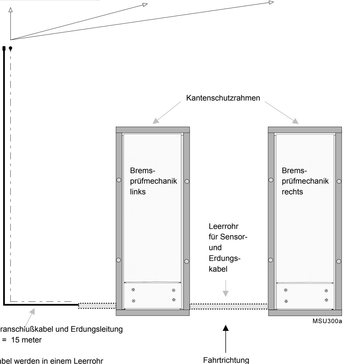
Sensoranschlußkabel und Erdungsleitung
