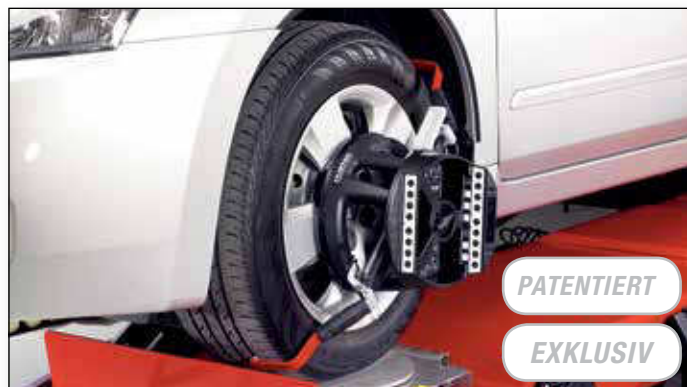
HawkEye Elite® Sensoren (HE421), werden mit QuickGrip™ Adaptoren und 3-Dimensionalen Reflektoren geliefert.
