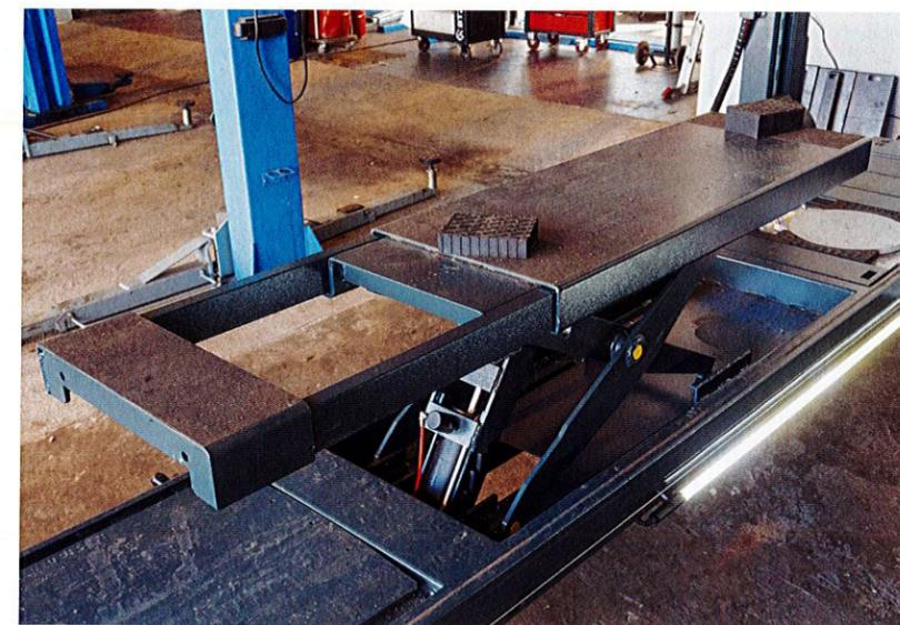
Mit einem Radfreiheber werden Viersäulen- und auch Scherenbühnen sehr universell – und ermöglichen auch Arbeiten am angehobenen Fahrwerk.
