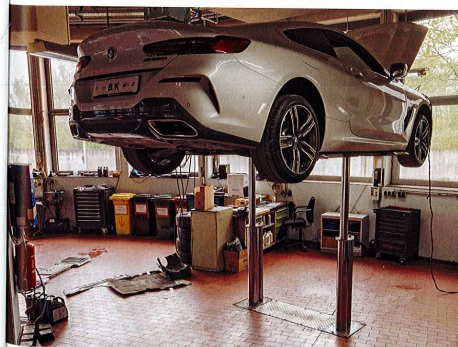
Aufgeräumt angehoben: Eine solche Zweistempelbühne ermöglicht freien Rundgang ums Fahrzeug. In abgesenktem Zustand...
