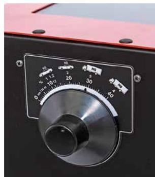
Einstellrad zur Verstellung des Prüfschirms.
