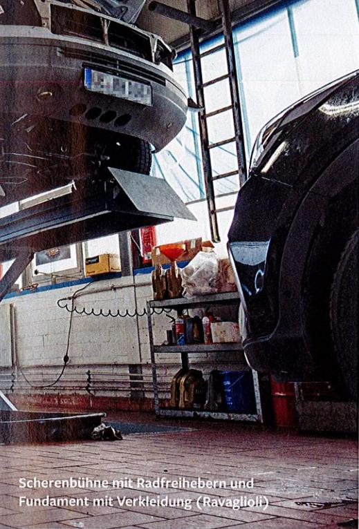
Scherenbühne mit Radfreihebern und Fundament mit Verkleidung (Ravaglioli)
