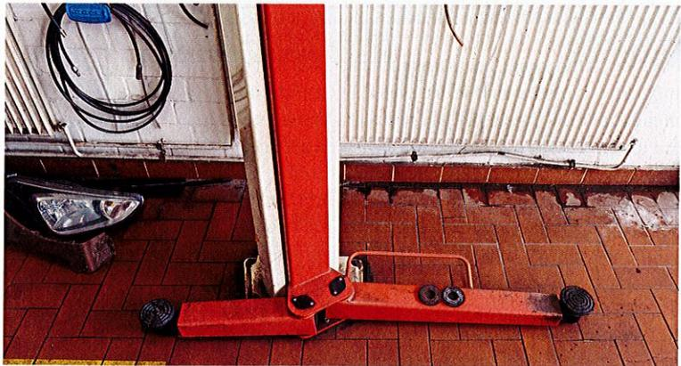
Asymmetrische Arme/eingedrehter Tragschlitten (Steril Koni)
