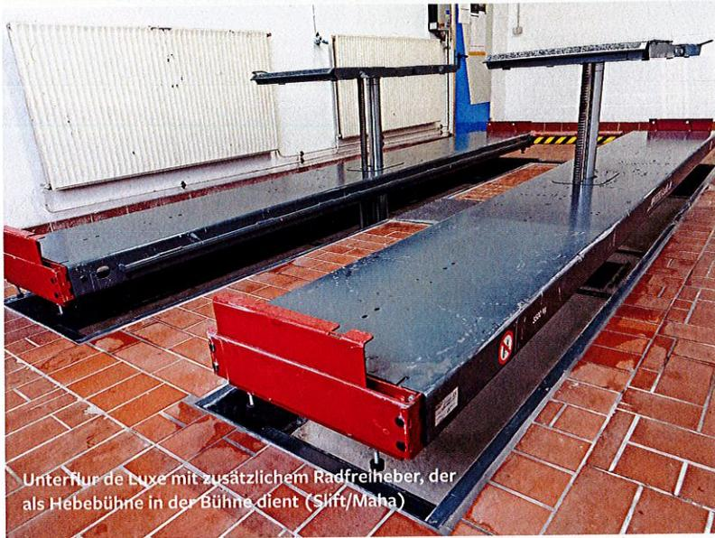
Unter der Luxe mit zusätzlichem Radfreiheber, der als Hebebühne in der Bühne dient (Sliff/Maha)
