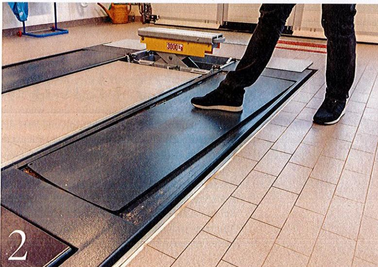
Bild 1: Je nach Höhe des Aufbaus müssen die Auffahrampen über zwei Meter lang sein.
