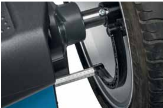
Elektronischer Datenarm ermittelt Felgenabstand/-durchmesser und die Position für die Klebegewichte
