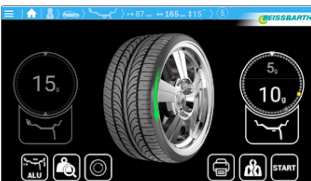
Versteckte Gewichtsverteilung hinter Speichen (SPLIT Programm/ASD-Funktion)
