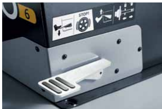
Neue Pedalfunktion: Nach unten: Blockiert Welle/ Rad. Hoch: löst/spannt den Pneumatikflansch
