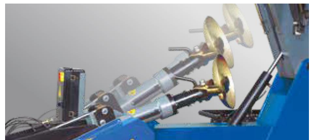
Radmittige Zustellung des Werkzeugarms ( patentiert )
