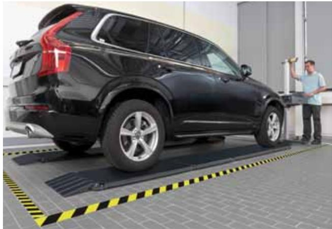
Nivellierbare Fahrzeugprüffläche LTB 100 gemäß § 29 StVZO HU-Scheinwerfer-Prüfrichtlinie
