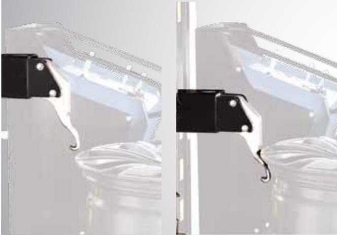
Werkzeug für den unteren Reifenwulst
