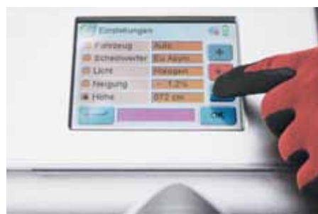
Bedienpanel um 180° verstellbar (Bedienung auch mit Handschuh)
