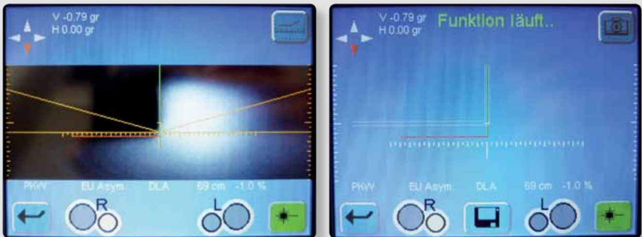
Einstellung eines Scheinwerfers mit Fernlichtassistent DLA (Testbild über Steuergerätediagnose am Fahrzeug)
