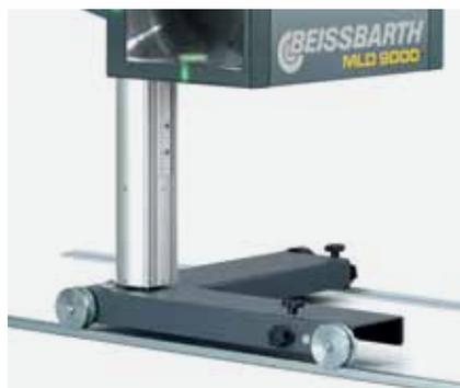
Optional: Schienensystem für unebene Prüfflächen
