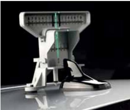
Positionstarget für die Dachantenne
