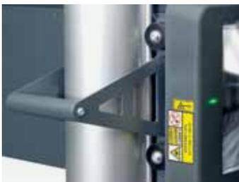
Leichter Schlitten für einfache Bedienung mit einer Hand
