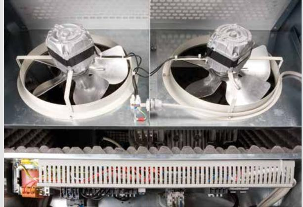
Zwei thermostatisch gesteuerte Abluftventilatoren sorgen für optimale Kühlung des Kompressors. Der von vorne und oben gut zugängliche, aufgeräumte Schaltschrank beinhaltet betriebssicher alle elektrotechnischen Komponenten.
