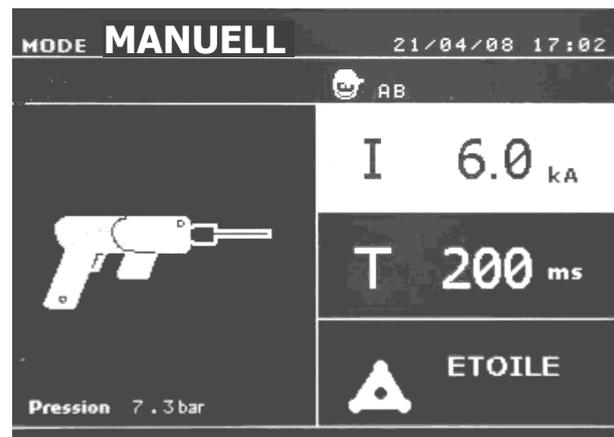
Die Monopunktpistole kann sowohl im STANDARD als auch im MANUELLEN Modus verwendet werden. Im STANDARD Modus ist die maximale Blechdicke auf 1.5mm begrenzt, wohingegen der MANUELLEN Modus die Leistung auf einen Maximalwert von 9.0 kA und 600 ms limitiert.
