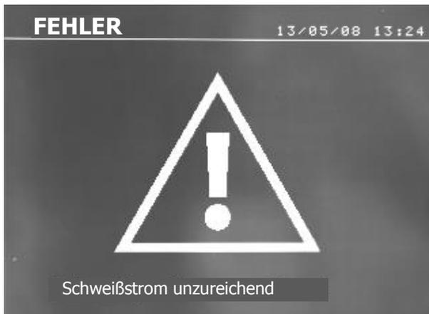
Liegt der Schweißstrom während der Schweißung mehr als 6% unter dem Sollwert, meldet die Steuerung «Schweißstrom zu niedrig», sobald der aktuelle Schweißpunkt beendet wurde. Der Punkt muss kontrolliert werden. Nach jedem Schweißpunkt werden im Display des Gerätes die gemessenen Werte für Schweißstrom und Anpressdruck angezeigt, bis ein neuer Punkt gesetzt oder eine Taste am Bedienfeld gedrückt wird.
