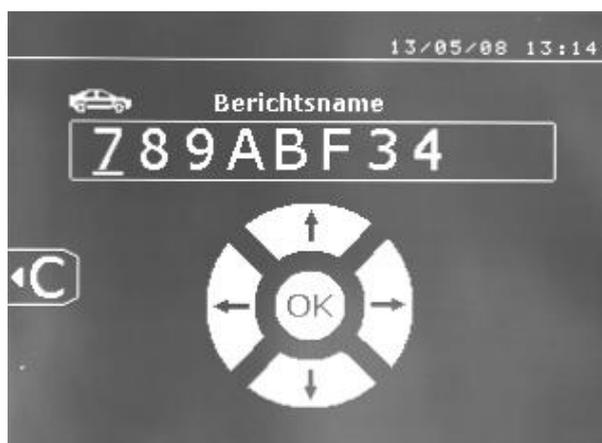
Die Aufnahme und Speicherung eines Berichtes auf der SD-Karte bietet die Möglichkeit eine Serie von Schweißpunkten auf Ihren PC zu übertragen und zu archivieren. Die hierfür benötigte Software wird Ihnen zusammen mit einer Kopie der Betriebsanleitung auf der im Lieferumfang enthaltenen SD-Karte mitgeliefert.
