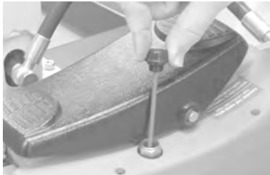
Deckel mit Messstab entfernen, um den Ölstand zu prüfen.
