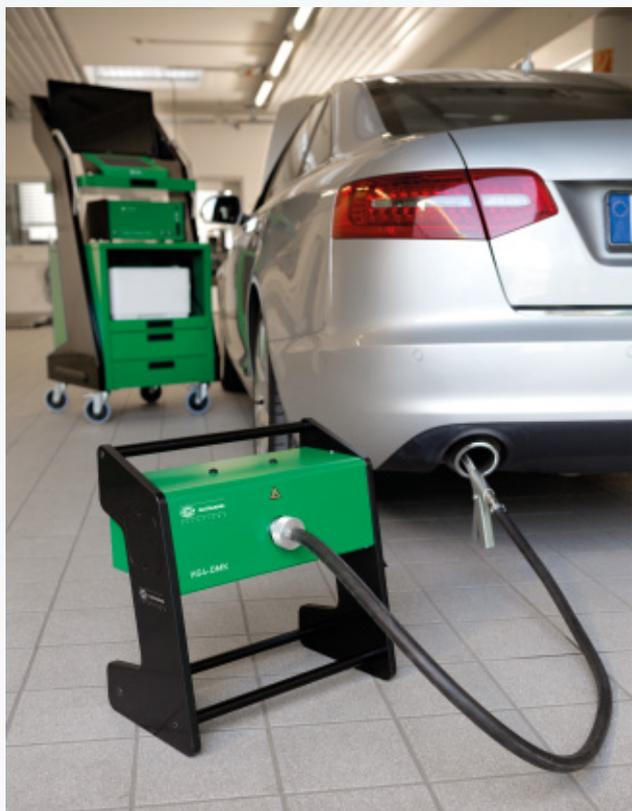
Superkompatibel, superhandlich: das neue hochauflösende Diesel-Opazimeter
