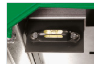
Mit Hilfe der Wasserwaagen-Libelle kann das SEG IV exakt auf das Niveau des Fahrzeugs angepasst werden
