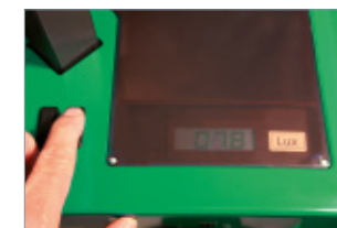
Über das digitale Luxmeter können der Blendwert des Abblendlichtes sowie die Beleuchtungsstärke des Fernlichts schnell und präzise ermittelt werden
