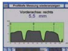
Profiltiefenmessung TM 1000: Automatische Messung des Profils über den ganzen Reifenumfang und die gesamte Reifenbreite.
