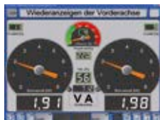
Bremstest Digitale und grafische Anzeige der Bremswerte.
