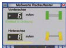
Radlauftest Übersichtliche Darstellung des Geradeauslaufverhaltens der Fahrzeugachsen.
