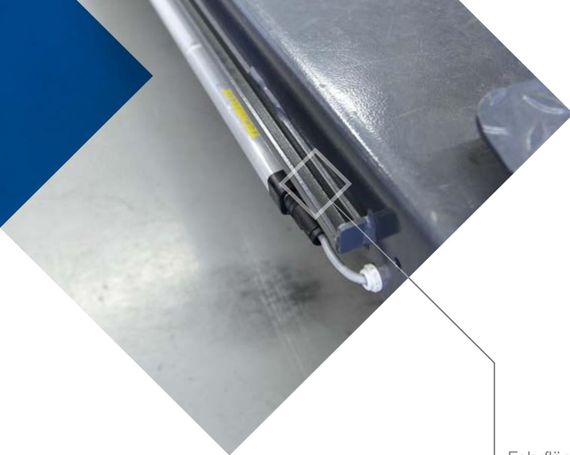
Absetzvorrichtung bei Fahrwerksvermessung serienmäßig, mit feinjustierbarer Absetzleiste und elektromagnetisch betätigten Klinken
