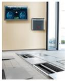
**Pkw-Bremsenprüfstand BD 4122**
