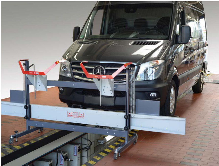
HD-30 EasyTouch mit Adapterset zur Vermessung von PKW und Transportern. Auch in Verbindung mit dem HD-30 Plus möglich.
