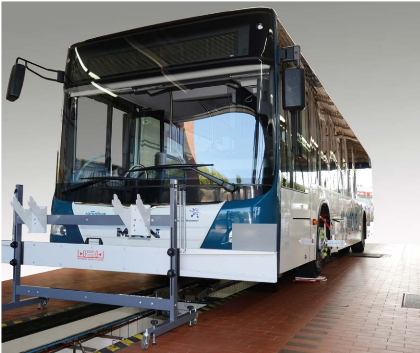
HD-30 EasyTouch in Verbindung mit dem HD-30 Plus zur Busvermessung
