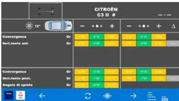
Während der Kontrolle der Achsgeometrie erlaubt die Software die Eingabe der Reifendurchmesser und zeigt den Sollbereich der Spurwerte, Halbspur und Fahrachswinkel an.
