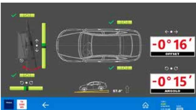
Die Anzeige "OFFSEET" zeigt an, wenn sich das RCCS 2 außerhalb der Fluchtung mit der Fahrzeugmitte befindet. "ANGOLO" hingegen zeigt an, um wieviel Grad die Struktur zur Fahrachse verdreht steht.
