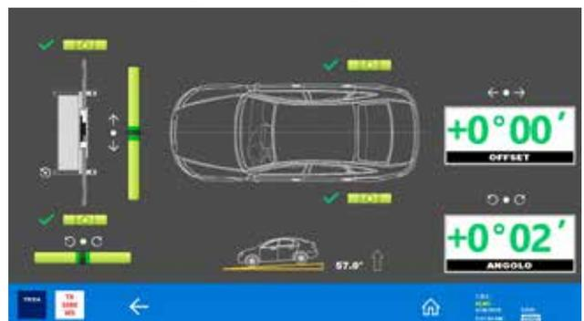
Die Einrichtung ist korrekt zum Fahrzeug ausgerichtet und es kann mit der Kalibrierung des Radars und der Fahrzeugkamera fortgefahren werden.
