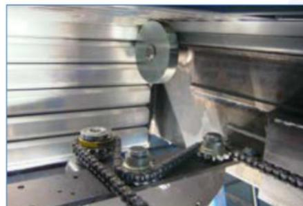
Sichere Kettenführung zur genauen Positionierung der Hubeinheiten
