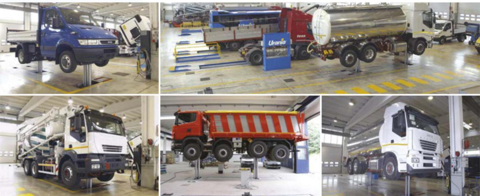
Mehr-Stempel-Hebeanlagen erlauben das schnelle und sichere Anheben großer Fahrzeuge und helfen dadurch zusätzliche Laufwege mit Werkzeugen und Material zu vermeiden.
