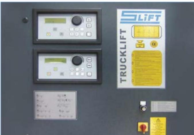
Zentrale Steuer- und Programmierereinheit mit zwei Displays.
