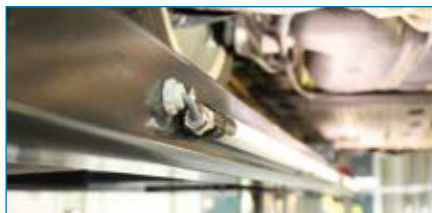
Drehbare LED-Beleuchtung zum einfachen Einstellen der Lichtrichtung, um blendfrei zu sehen.
