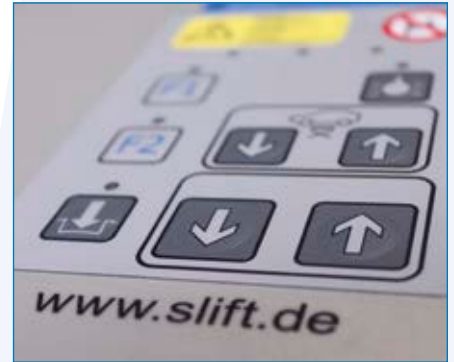
Folientastatur mit leichtgängigen Mikroschaltern
