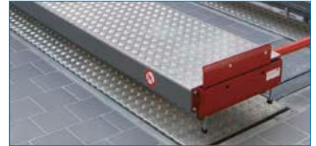
Aluminiumbeplankte Fahrflächen mit Abkantung für besseren Wasserablauf.
