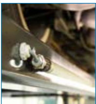
Drehbare LED-Beleuchtung zum einfachen Einstellen der Lichtrichtung, um blendfrei zu sehen.
