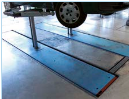
Fahrflächen Hebebühnen mit Nachhubeinrichtung (1860 mm) und vollwertigem Radfreiheber.
