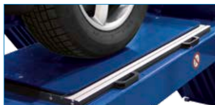
Präzisions-Schiebeplatte Minimales Losbrechmoment 5 Nm und minimale Verschiebekraft 15 N, Auffangrillen für Schmutzwasser.
