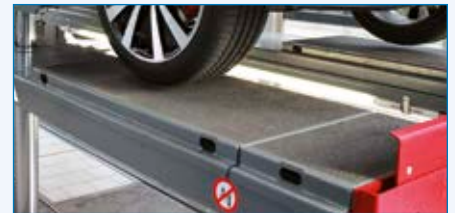
Fahrflächen mit Ausgleichsplatten zum Niveaueingleich an den Radfreiheber oder an die Achsvermessung.
