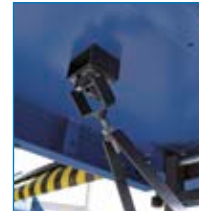
Befestigungssystem und Arretierung der Fahrflächenabstützung.
