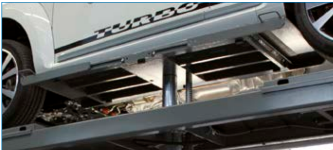
Fahrflächen-Hebebühnen mit Plattform-Radfreiheber, Schwelleraufnahme Traglast 3,5 t
