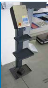
Steuerung auf einer Funktionsstandsäule, zu freien Aufstellung montiert
