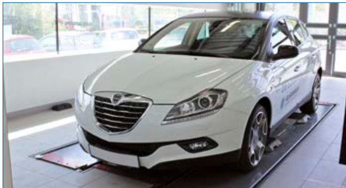
Abgesenkt zum einfachen Befahren auch mit geringer Bodenfreiheit
