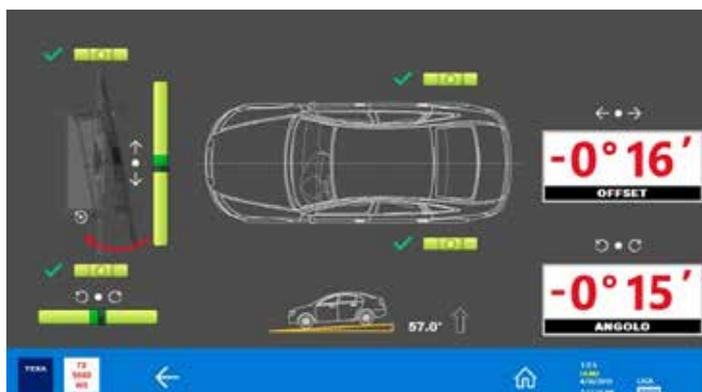
Die Anzeige "OFFSET" zeigt an, wenn sich das RCCS 3 außerhalb der Fluchtung mit der Fahrzeugmitte befindet. "ANGOLO" hingegen zeigt an, um wieviel Grad die Struktur zur Fahrachse verdreht steht.
