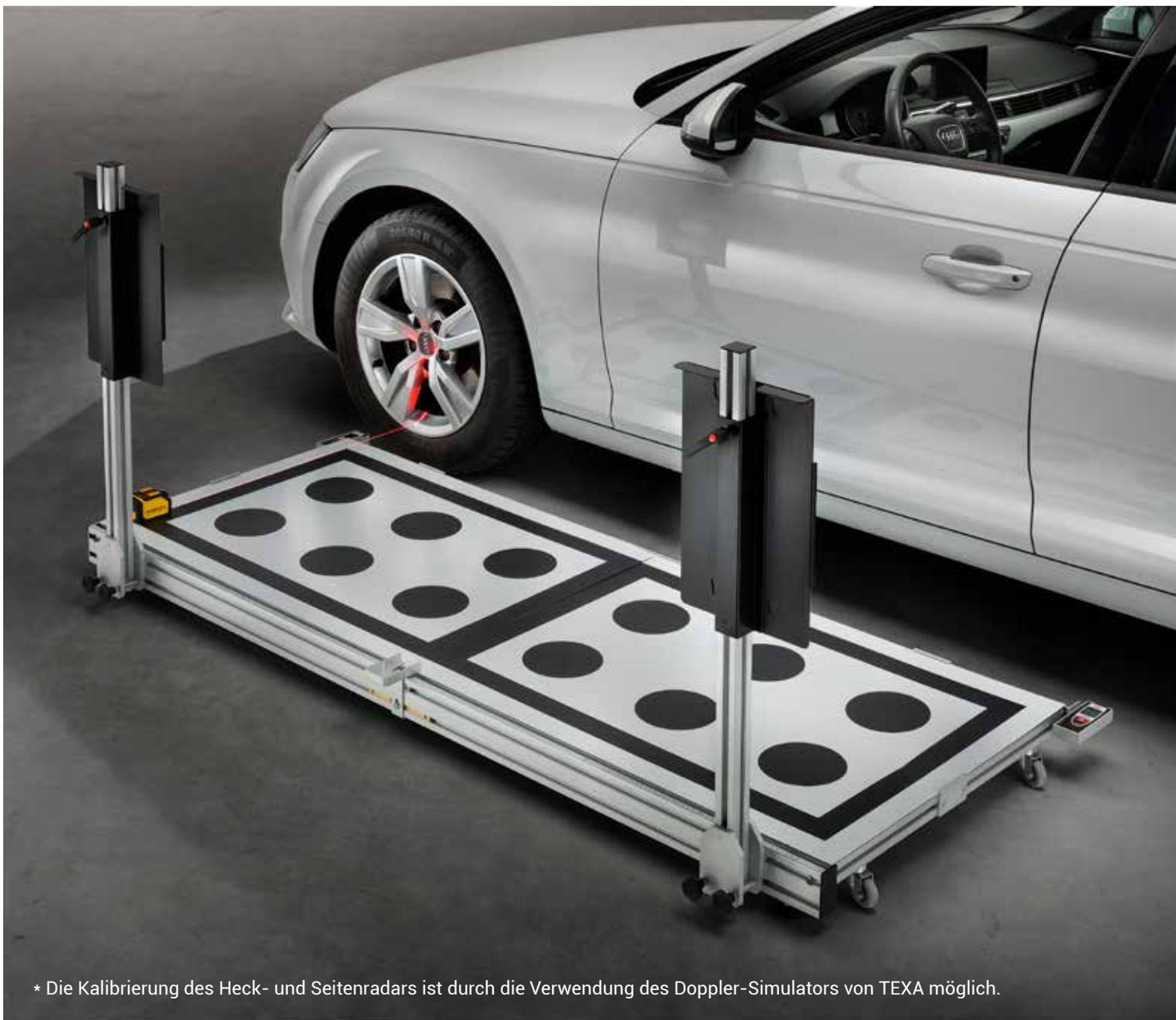
\* Die Kalibrierung des Heck- und Seitenradars ist durch die Verwendung des Doppler-Simulators von TEXA möglich.
