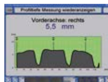
Profiltiefenmessung TM 1000: Automatische Messung des Profils über den ganzen Reifenumfang und die gesamte Reifenbreite.
