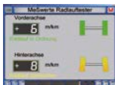
Radlauftest Übersichtliche Darstellung des Geradeauslaufverhaltens der Fahrzeugachsen.
